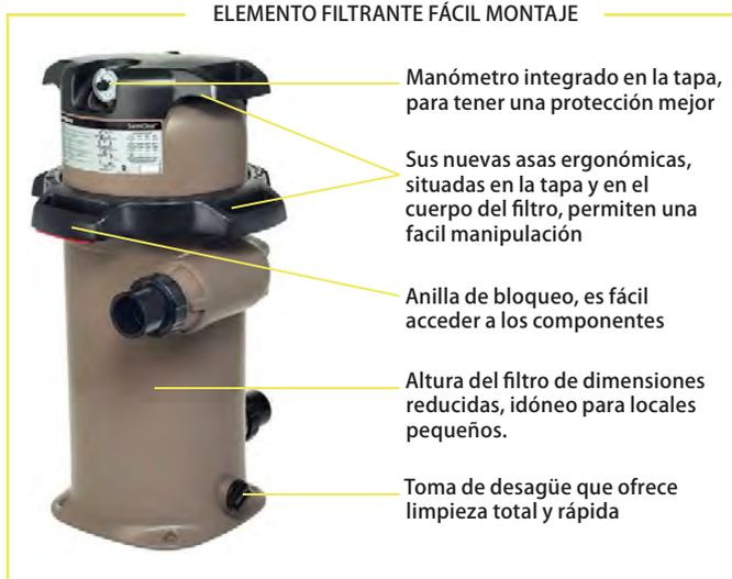
ELEMENTO FILTRANTE FÁCIL MONTAJE
